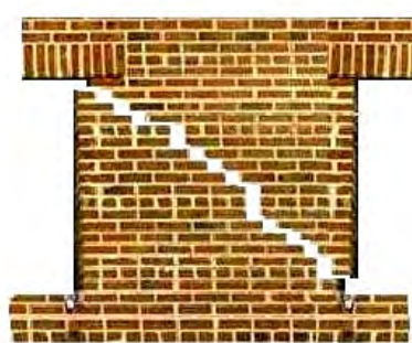
شکل (د) شکست حاکم بر رفتار دیوارهای با مصالح بنایی
