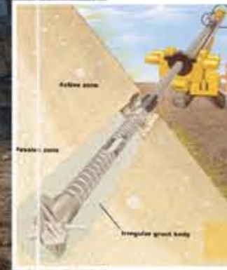
تثبيت خاک با روش Nailing
